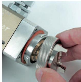
Desmontaje de 1/4 de vuelta del cabezal
