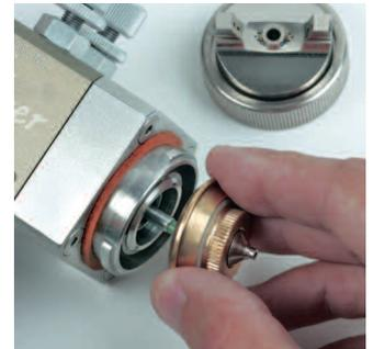
Desmontaje de 1/4 de vuelta del pico de fluido
